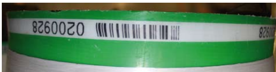
Über die umlaufend am Umband angebrachten Barcodes lassen sich Prozessparameter eindeutig dem jeweiligen Produkt zuordnen.
