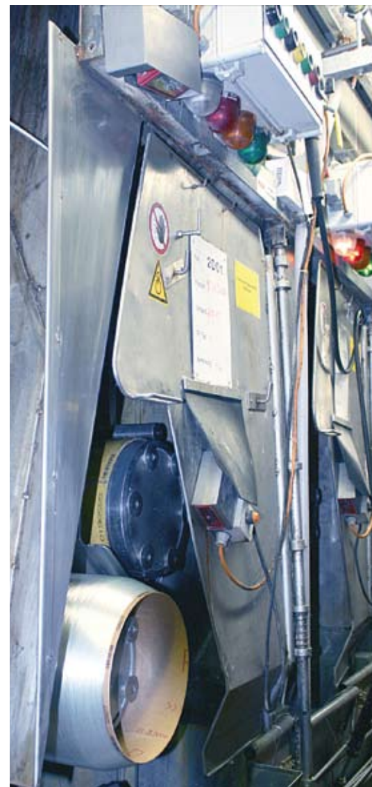
Die durchgängige Identifikation der Produkte beginnt bei Saint-Gobain Vetrotex beim Wickelprozess im Spulraum. Hohe Feuchtigkeit, bedingt durch Wasser und Schlichteemulsionen, sorgen für extreme Umgebungsbedingungen, die die Lesbarkeit der Codes beeinträchtigen.
