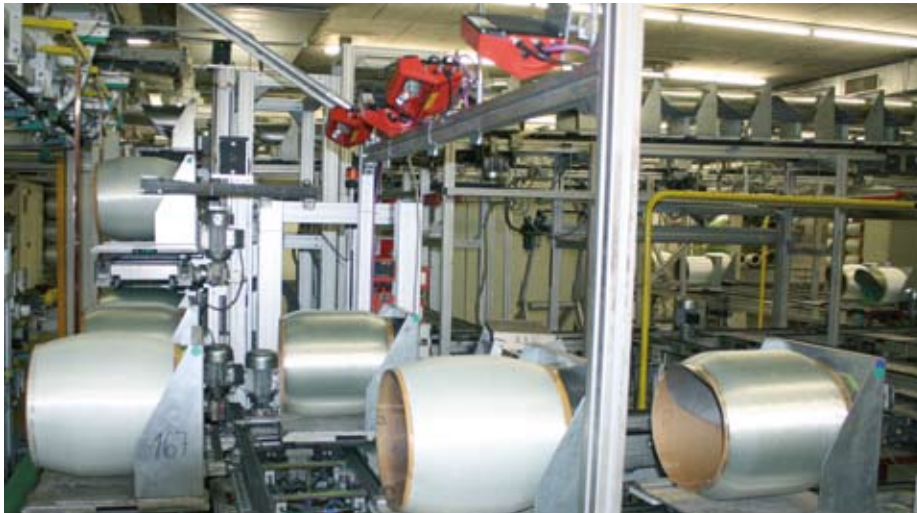
Die Barcode-Lesegeräte BCL 500i erkennen mit ihrer hohen Leseperformance auch die oftmals sehr beschädigten Barcodes am Umband zuverlässig.
