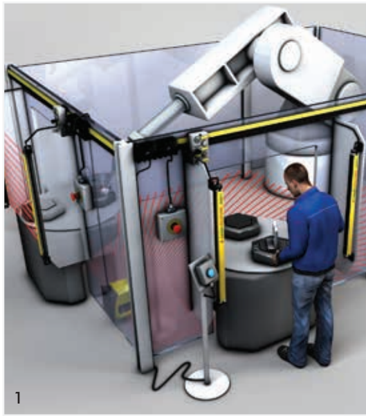
1 Gefahrenstellenabsicherung durch Lichtvorhang mit AS-Interface 2 Großflächige Gefahrenabsicherung mittels Scanner 3 Absicherung mit Einstrahlsicherheitslichtschranken 4 Einfache Zugangsabsicherung mit Laserausrichthilfe
